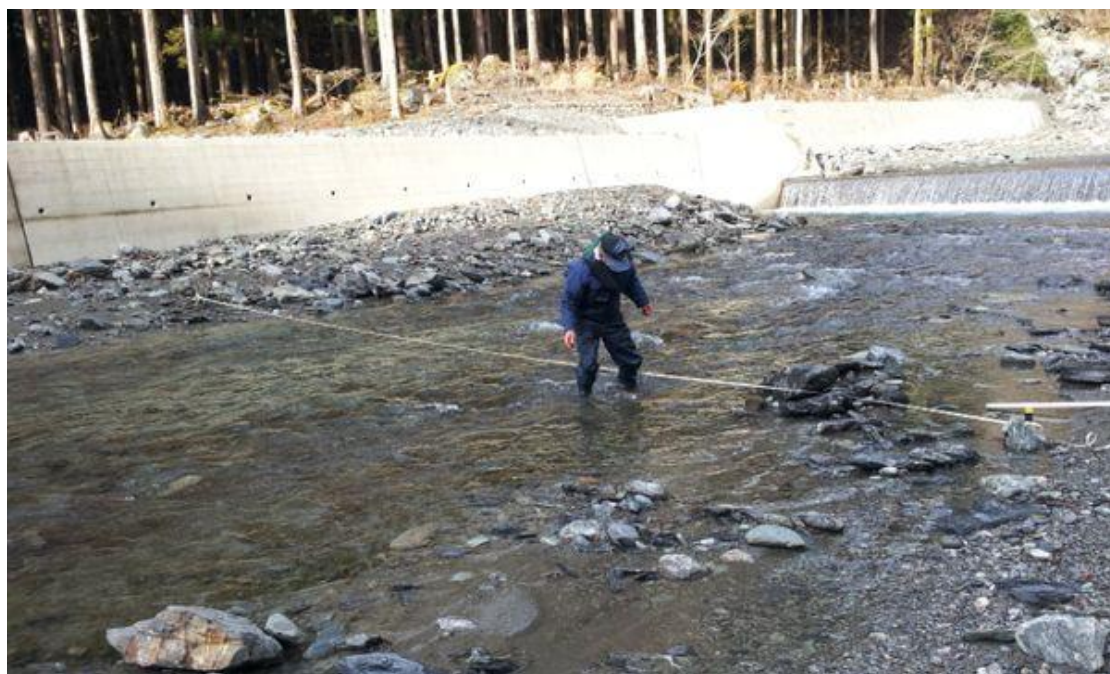
写真 香美市西熊溪谷 流量測定の様子
